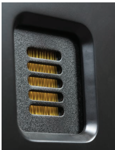
Martin Logan przyłączył się do producentów załascynowanych wynalazkiem Oskara Heila – przetwornikiem, w którym membrana pracuje jak harmonijka, wypychając powietrze z dużą prędkością spomiędzy swoich fałdów. Stąd firmowa nazwa – Folded Motion Transducer – chociaż oryginalna brzmi: Air Motion Transformer .
