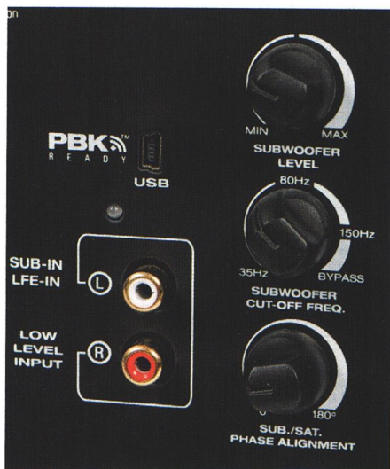
Klasyczny zestaw trzech regulacji - poziom, częstotliwość filtrowania, faza; wejścia tylko niskopoziomowe, wystarczą we wszystkich systemach wielokanałowych i w połowie systemów stereofonicznych; firmową specjalnością jest opcjonalny system PBK (korekcji charakterystyki).
