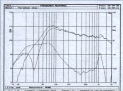
rys. 6a. CC-470, działanie bass-refleksu.
