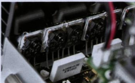
Każda końcówka mocy składa się z dwóch układów Sanken.
