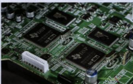
Do roli układów przetwarzających dźwięk surround wybrano dwa programowalne procesory DSP Texas Instruments.
