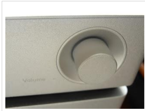
Pokrętko głośności - do użytku wyłącznie z aktywnym cyfrowym wejściem optycznym
