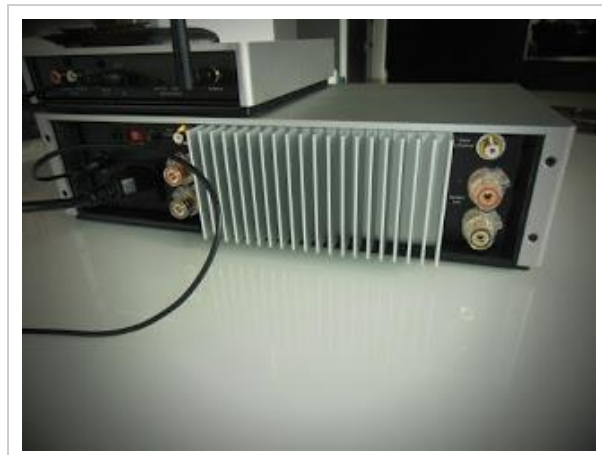
Aluminiowe radiatory; bardzo solidne terminale głośnikowe
