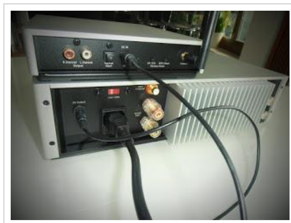
Zasilanie przedwzmacniacza może pochodzić z zasilacza impulsowego lub bezpośrednio z końcówki mocy (na zdjęciu powyżej)
