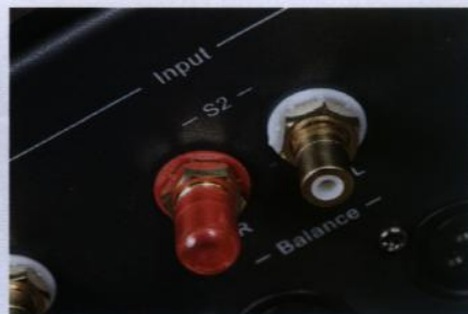
Gniazda RCA zabezpieczono gumowymi nasadkami.
