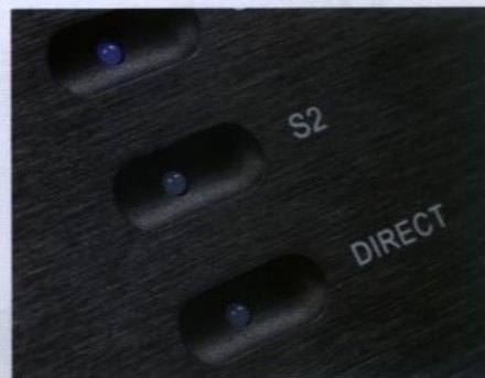
Prosty selektor wejść sekwencyjnie przełącza między źródłami, aktywne jest sygnalizowane niebieską diodą.
