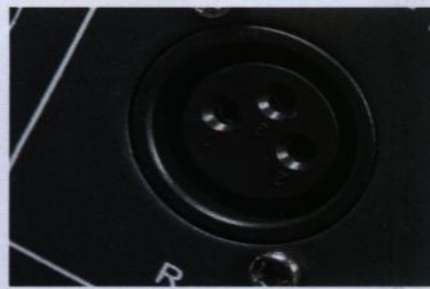
Gniazda XLR nie powinny nas zmylić ani nawet za bardzo kusić – zaraz za nimi sygnał jest zamieniany na niesymetryczny.
