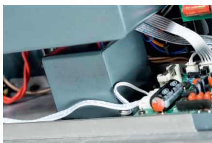
Ponieważ potencjometr znajduje się blisko transformatora, został zaekranowany.
