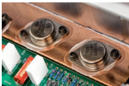
Miedź, a na niej tranzystory w obudowie TO-3. Kiedyś norma – dzisiaj rzadkość.
