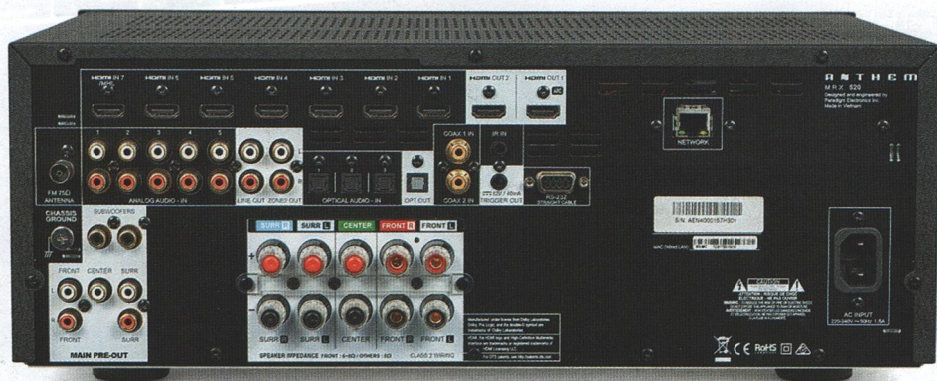
Wyposażenie w zakresie gniazd wizyjnych ograniczono do złącza HDMI.
