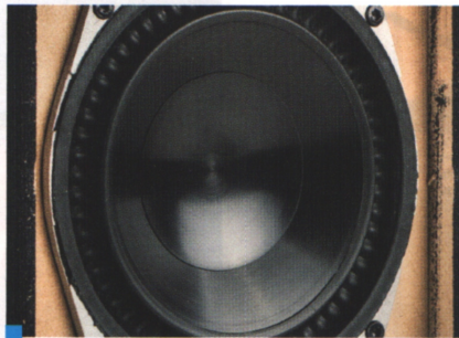
Miękką, szczególnie przy brzegach, membraną usztywnia centralna nakładka. Warto zwrócić uwagę na zawieszenie ART (Active Ridge Technology).
