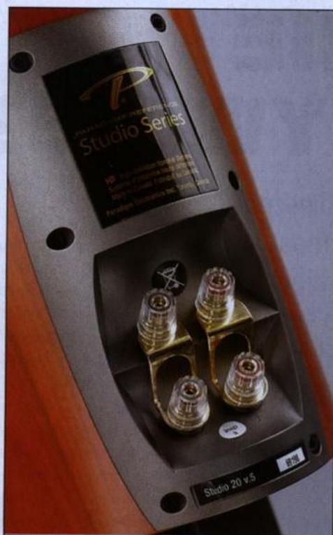
Gniazda – masywne i wygodne, ale zworki lepiej zastąpić krótkim odcinkiem kabla
