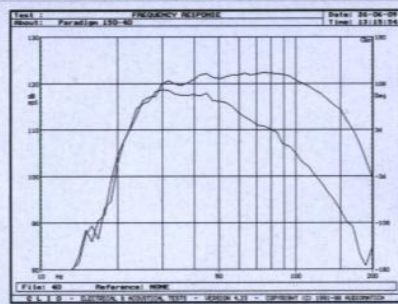
rys. 2. Charakterystyki dla skrajnych pozycji regulatora górnej częstotliwości granicznej.
