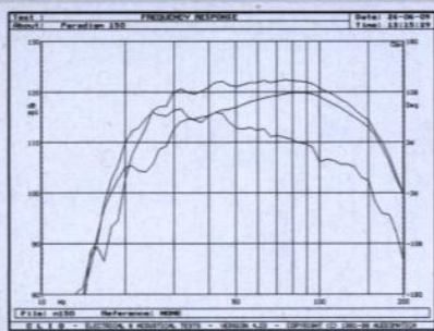
rys. 1. Charakterystyka głośnika, membrany biernej i wypadkowa, dla najszerszego pasma.
