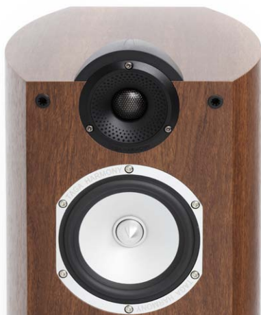
Die Mittelhochtoneinheit besteht aus einem 13 Zentimeter großen Konustöner und einer 25 Millimeter kleinen Kalotte
