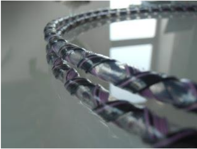
Zbliżenie na geometrię interkonektu typu "Field-Balanced"
