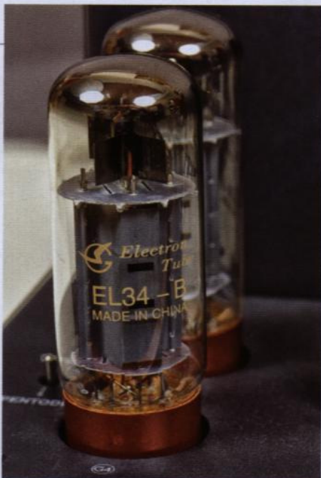
Popularne lampy EL34 pojawiają się w wersji „B”, oznaczającej produkcję (chińską) selekcyjonowaną „militarnie”.
