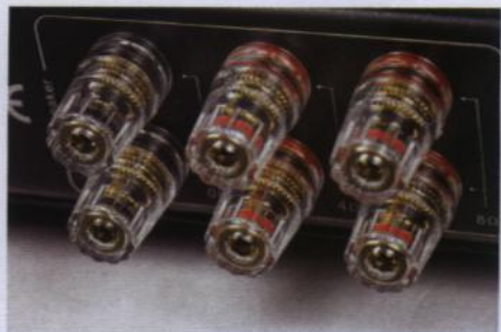
Dwa zestawy zacisków głośnikowych (a dokładnie zacisków dodatnich) wyprowadzone są z odczepów transformatorów przygotowanych dla obciążeni 4- lub 8-omowych.
